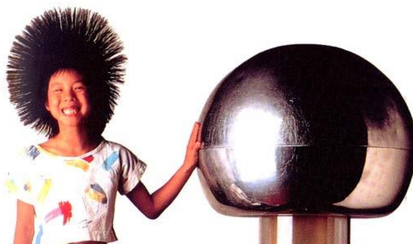
ภาพที่ 8 แสดงการทำงานเครื่องกำเนิดไฟฟ้าสถิต (Van de graaff generator)
