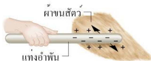
ภาพที่ 6 แสดงประจุลบจากผ้าขนสัตว์ติดบนแท่งอำพัน ทำให้แท่งอำพันมีประจุลบ และผ้าขนสัตว์มีประจุบวก
